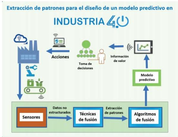
Figura 1. Diseño de modelo de mantenimiento predictivo
