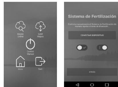
Figura 4 y 5. Menú del APP (Izquierda), el usuario a través de esta pantalla puede acceder a sus mapas online, subir los mapas, y el control manual del sistema de fertilización. La Interfaz que permite el Control del Sistema de fertilización
