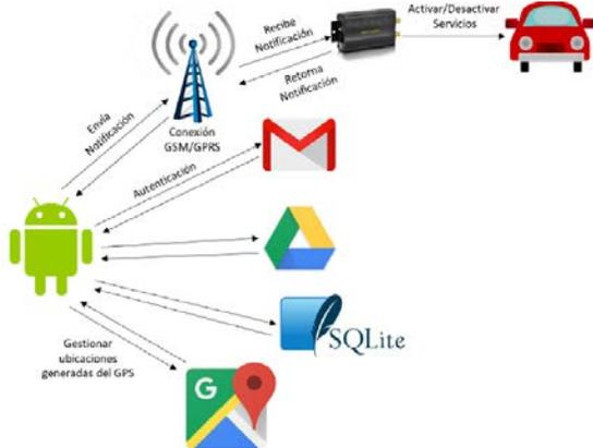
Figura 6. Esquema general de la aplicación. Fuente: Elaboración propia.
