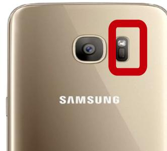
Figura 1.- Sensor HRM del teléfono Samsung S7 Flat
